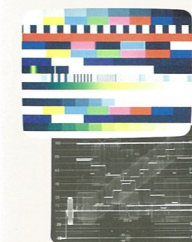
例1 一画面を横方向に分割 (NTSC: 最大16種類 PAL: 最大8種類) し、任意の映像信号を割り当てたマルチパターンです。マルチパターンは4種類までプリセットできます。
