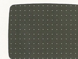
DOT コンバージェンスや直線性のチェック・調整ができます。
