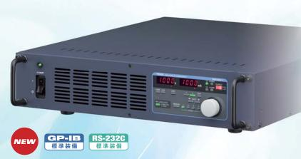
PDK1000-1は定格出力が電圧0~1000V、電流0~1000mA、電力0~1000Wの定電圧・定電流可変型の直流安定化電源です。
