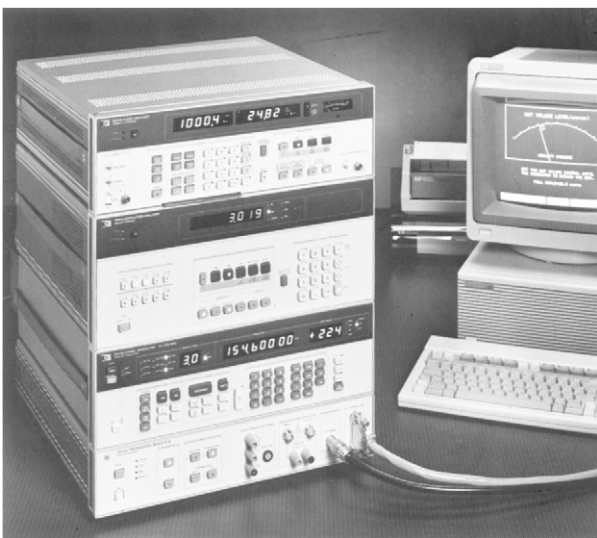
移動無線機の自動試験システムの例
